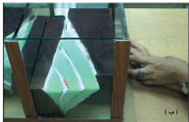
تصویر ۶- سمت راست: ساختار گل مانند منفی قبل از حرکت (الف) و بعد از حرکت (ب)، گسل‌ها از نوع عادی با مؤلفه‌های چپ لغز هستند. سمت چپ: ساختار گل مانند مثبت قبل از حرکت (الف) و بعد از حرکت (ب)، گسل‌ها از نوع معکوس با مؤلفه‌های چپ لغز می‌باشند.
